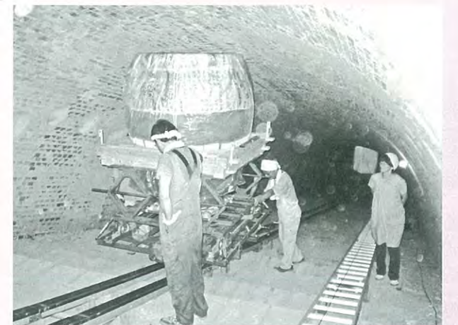
五石甕 窯詰め作業
